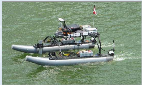
무인 자율항해용 소형 LIDAR(MIT대)
