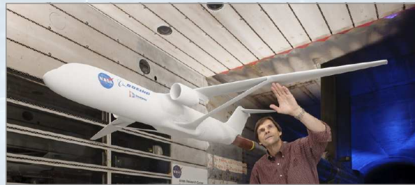
트러스지지 날개 항공기의 풍동시험 모델
