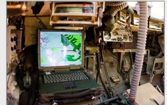
장갑차량에 설치된 안드로메다-D 자동통제체계
