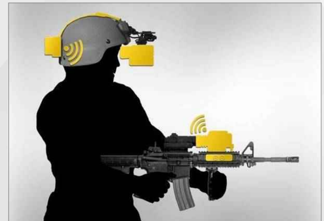
헬멧 착용 ENVG-III, 소화기 설치 FWS-I에 무선 연결
