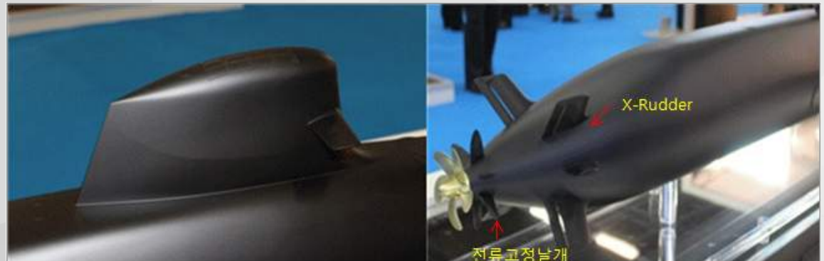
DCNS사의 스콜펜 2000 혁신형 모델의 세일(좌)과 함미부분 전류고정날개 및 X-rudder 형상(우)
