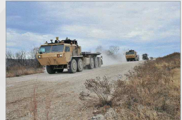
무인임무 모듈 통합한 M915 트럭 시험 중
