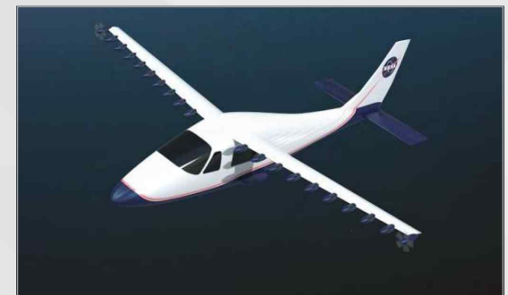
LEAPTech 날개를 사용한 소형 항공기의 개념도
