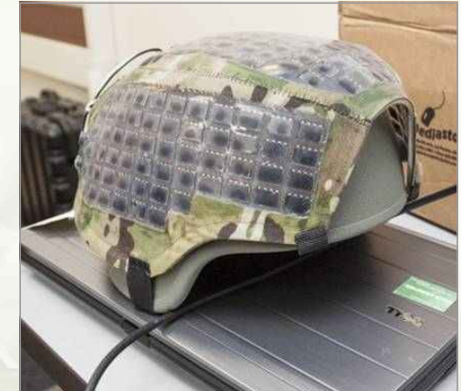
▶ Solar Panel Harvester 태양전지 패널 에너지 포집장치 : 배낭 부착 패널은 10와트, 헬멧 부착 패널은 7와트의 전력을 생성
