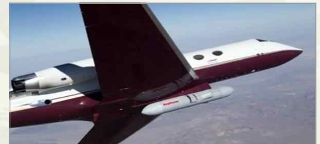
▶ Calspan사의 Gulfstream 비즈니스 제트기 하부에 장착된 재머포드
