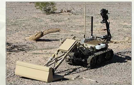
▶ 무인지상차량에 설치된 AMDS
