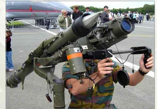
▶ Matis MP3 광전자 조준경을 장착한 Mistral 단거리 지대공 방공미사일체계
