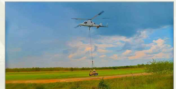
▶ K-MAX 무인헬기에 의한 SMSS 무인지상차량 이동
