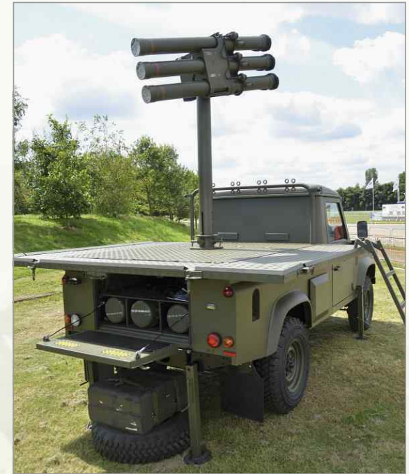
▶ 신형 Starstreak 지대공 미사일 차량의 사격 플랫폼 아래에 6개의 재장전용 탄약 저장 공간이 있음
