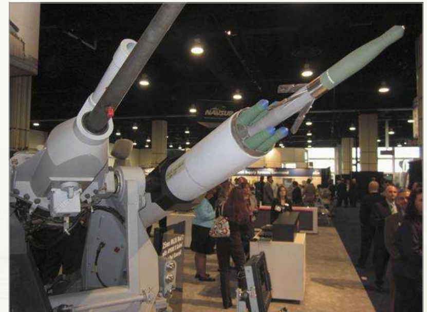
▶ 미 해군의 표준 25mm포 Mk 38 mod 2 거치대에 설치된 첨단정밀타격 무기체계(APKWS) 유도 로켓용 발사관
