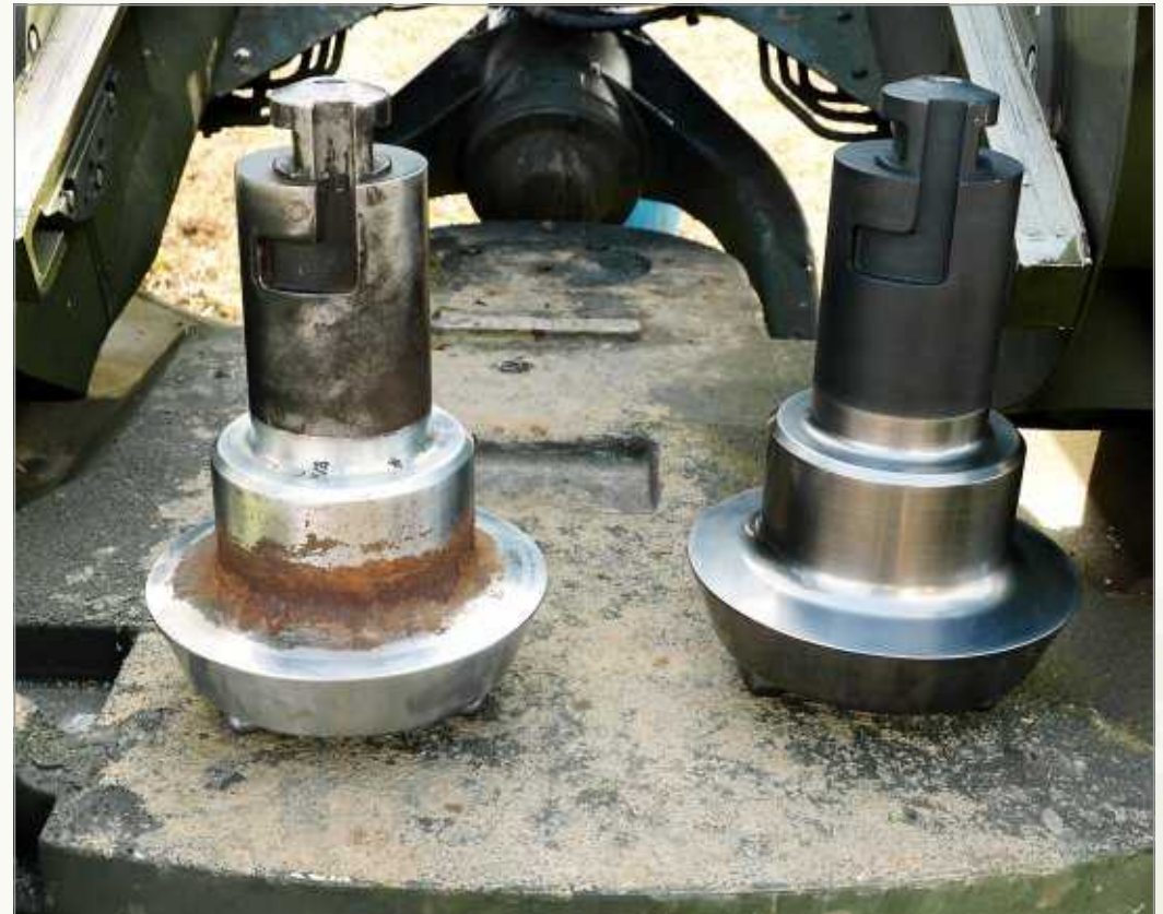
▶ 미국 매릴랜드 주 소재 미 육군 Aberdeen 시험센터에서 M776 곡사포의 부식된 크롬도금 표준 폐쇄기 굴대가 새로이 도금한 제품 옆에 놓여 있다.
