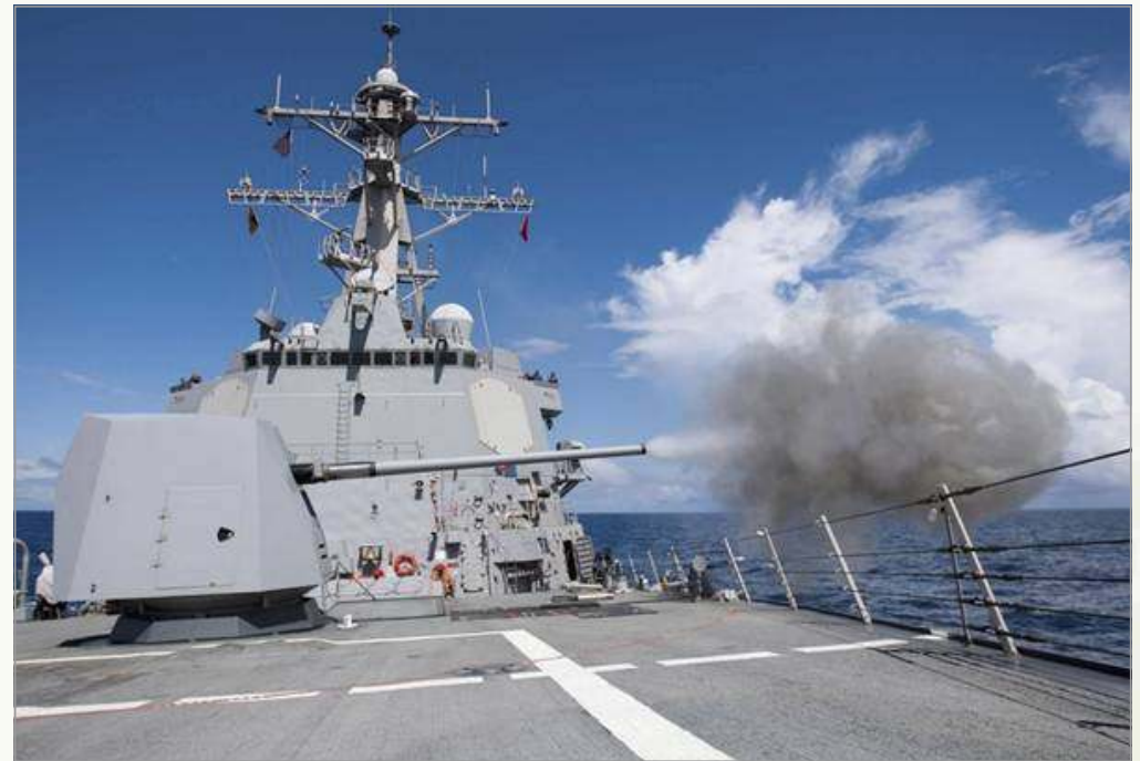
▶ 미 해군의 Arleigh Burke급 유도미사일 구축함 USS Pinckney호에 탑재된 Mk 45 Mod 4, 5인치 /62구경장 함포가 연습기간 중 사격을 하고 있다.
