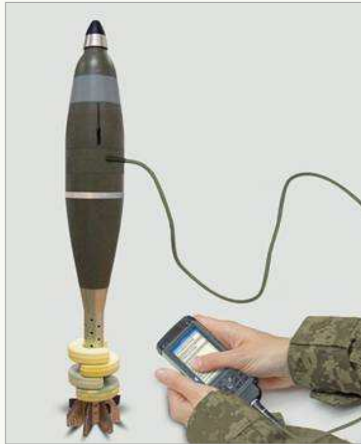
▶ 박격포에 장전하기 전에 휴대용 컴퓨터 설정기를 이용하여 계산한 4개의 추가장약을 부착한 120 mm GMB탄
