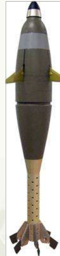
▶ 120mm GMB탄의 일부분인 비행체로서 연장된 조종날개 서보장치 (servo canard) 가 보임
