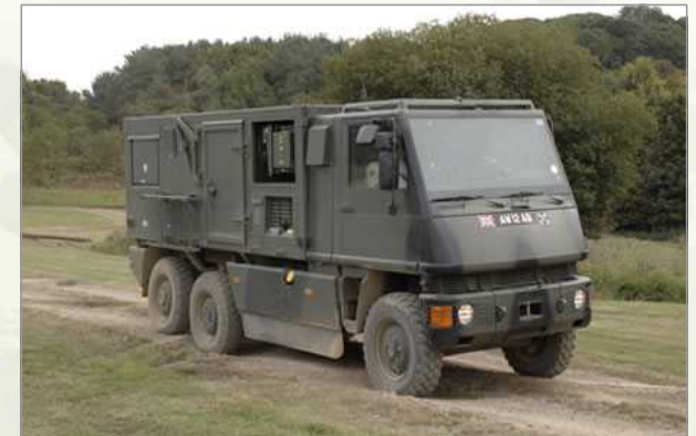
▶ TIGAS를 갖춘 쉘터를 장착한 MOWAG Duro II 6×6 차량
