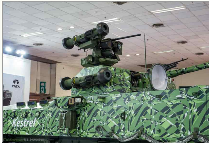
▶ Javelin 미사일 2기, 40mm 원격조종포탑 Kongsberg 탑재한 Kestrel LARV
