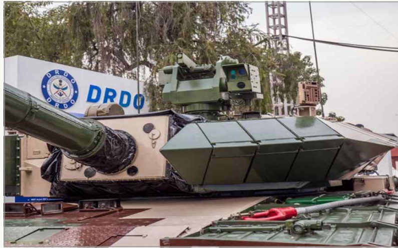
▶ Arjun Mk II에 탑재된 모듈식 특수장갑, 포탑상부 탑재원 원격조종 무장장치 (우측 경고장치(황갈색) 레이저 탑재)
