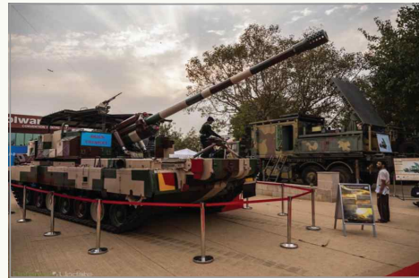
▶ 인도 주력전차 Arjun Mk II 기반 130mm 자주포 Catapult Mk II
