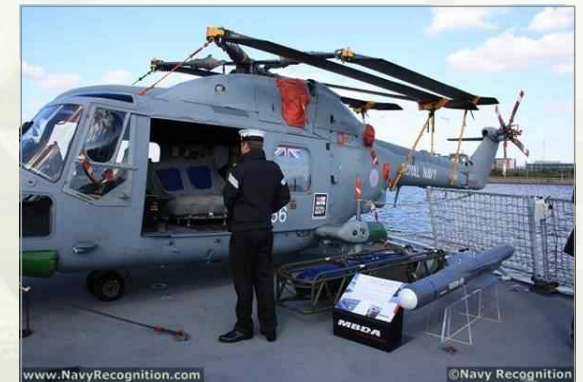
▶ 영국 해군의 데어링급(Type 45) 구축함에 실린 Lynx 헬기 옆의 FASGW(H) 미사일 모형
