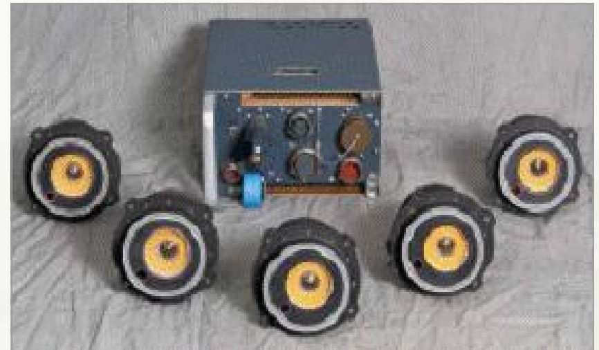
▶ CMWS는 회전익 항공기, 수송기 및 전술 항공기에 대한 IR 위협을 감지할 수 있도록 설계되었다.
