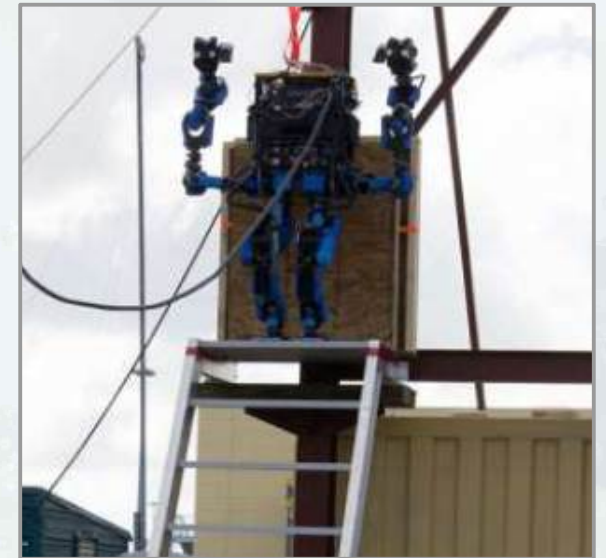
일본 샤프트(SCHAFT) 팀의 무게 95킬로그램의 이족보행 로봇으로 특별히 DRC용으로 개조된 HRP-2 로봇
