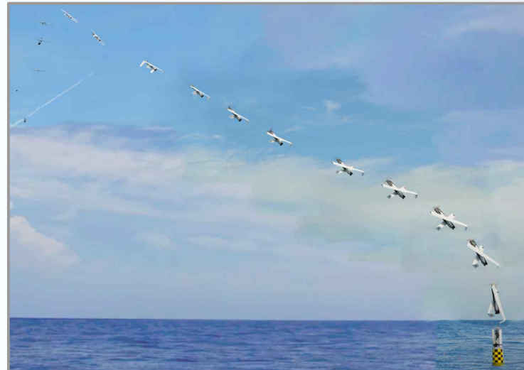
수중의 잠수함으로부터 시험 발사되는 XFC UAS 무인기
