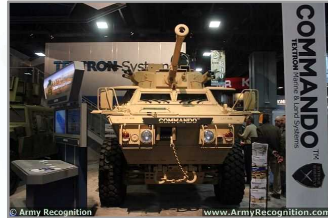
Textron Marine&Land Systems사의 90mm포 탑재 신형 4×4 장갑차 Commando
