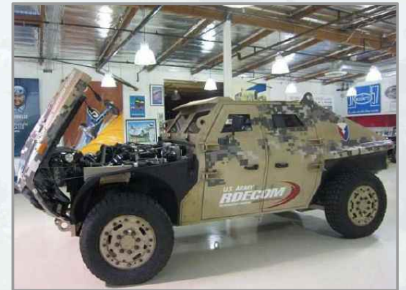
Alcoa사의 장갑판 ArmX 5456-H151를 미 육군 고연비 지상차량 시연차량 FED ALPHA에서 입증
