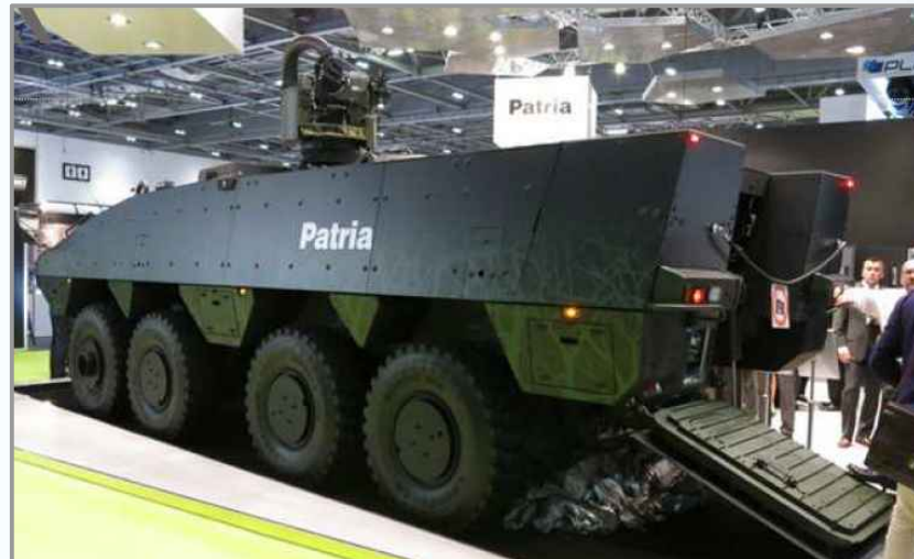
핀란드 Patria사, 현 AMV(Armoured Modular Vehicle)에 비해 탑재하중이 10% 증가된 차륜형 콘셉트 장갑차 (8x8)
