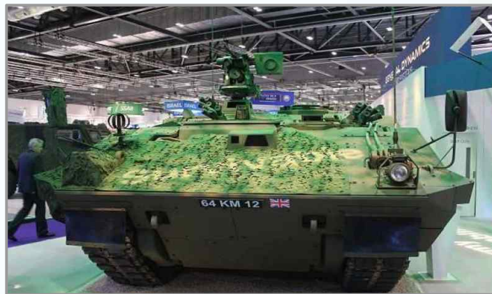
영 제너럴 다이내믹스사, 차세대 궤도형 장갑차 SV의 기동 시험용 시험차량(Mobile Test Rig, MTR)
