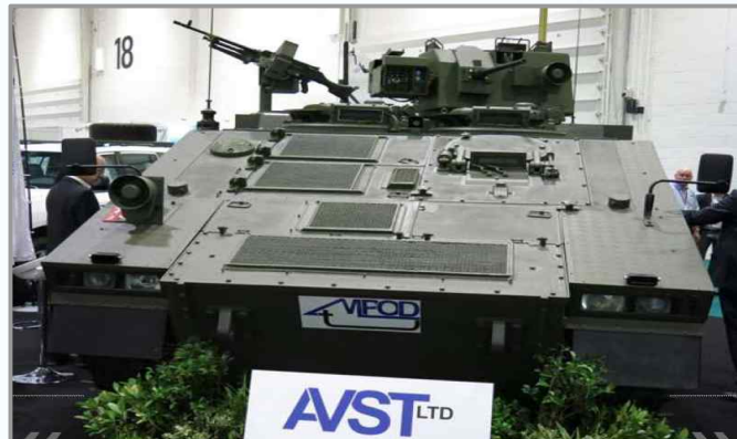
영 AVST사, CVR(T) 새시에 mPOD 임무모듈을 탑재한 다목적 모듈식 퀘도형 장갑차. mPODt 첫 선
