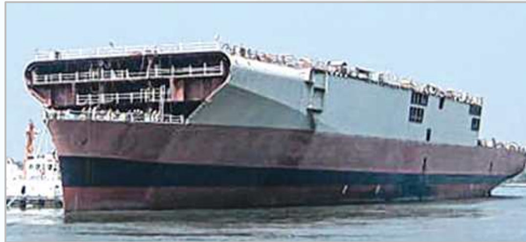
인도 국영 철강사인 SAIL은 현재까지 P-71 항공모함 건조에 약 28,000톤의 특수강을 공급함
