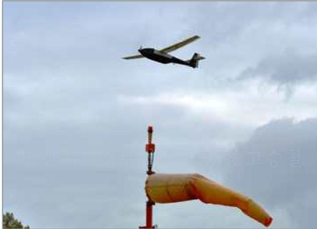
액화수소를 이용한 Ion Tiger 무인기의 비행 모습
