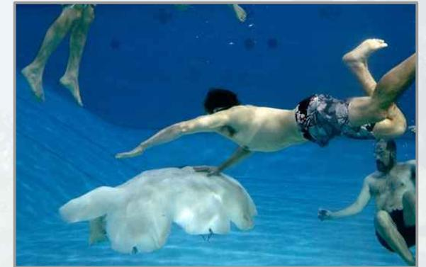
로봇 해파리 수중 시험 모습
