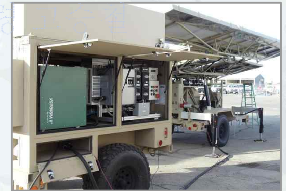
트레일러 장착 재생연료전지 시스템(미 해군)
