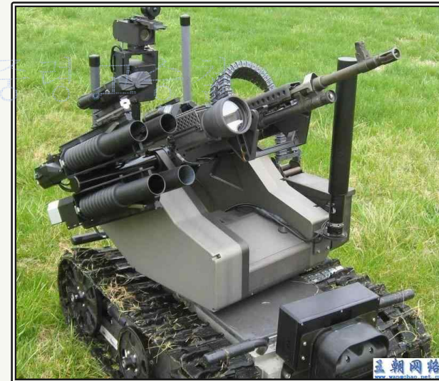
미국의 전투 로봇 SWORDS(Special Weapons Observation Remote Direct-Action System)
