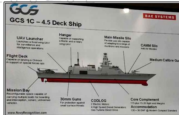
그림. Type 26 호위함의 새로운 설계 개념도
