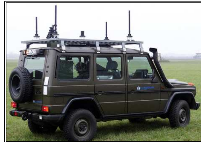
그림 CASSIDIAN사의 신형 차량방호 재머장착 차량
