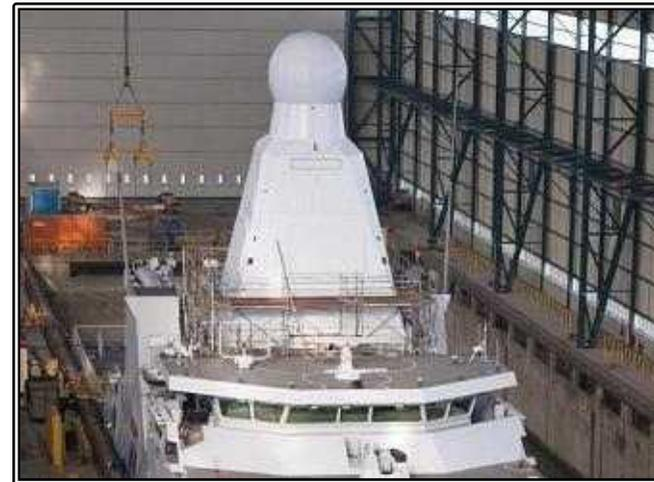
그림. 건조 중인 Holland함에 설치된 통합마스트
