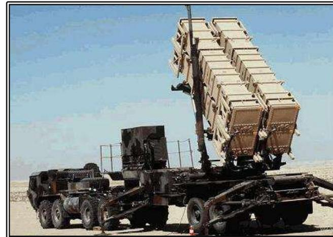
그림. Patriot 지대공 미사일 시스템
