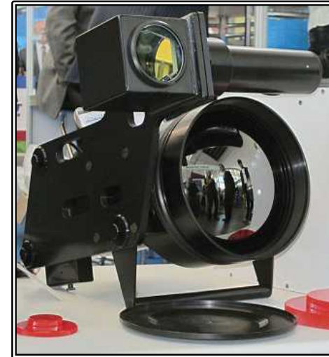
그림. 비냉각 센서 방식의 TV-M 야시경
